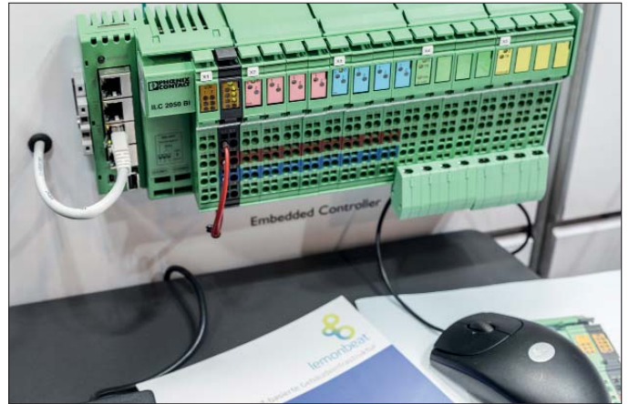
Bild 4: Der modulare Inline-Controller für Automatisierungsanwendungen von Phoenix Contact spricht jetzt auch „Lemonbeat“ und wird mit der IoT-Managementplattform „Emalytics“ verbunden
