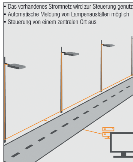
Bild 3: Lichtsteuerung über Powerline-Verfahren
