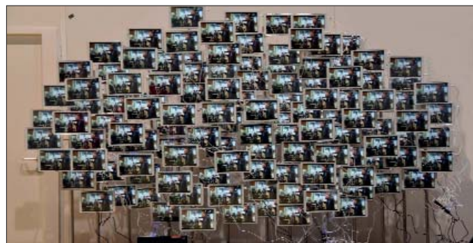
Bild 1: Unter den vielen Demonstratoren des 5GLabs sticht die zuverlässige Versorgung von hundert Endgeräten mit Multicast-Inhalten über 5G besonders ins Auge (Quelle: 5GLab Dresden)
