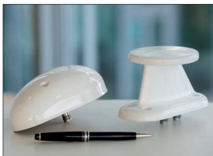
Bild 2: Die EAN-ACGC-LTE-Antenne (ACGC – Aviation Complementary Ground Component, rechts) stellt die Kommunikation zum Bodennetz sicher, während das EAN-MSS-Terminal (MSS – Mobile Satellite Services, links) mit dem S-Band-Satelliten kommuniziert (Foto: Thales)
