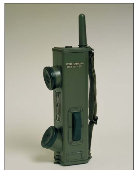
Bild 2: Das Handie-Talkie SCR536, ein tragbares AM-Funkgerät
