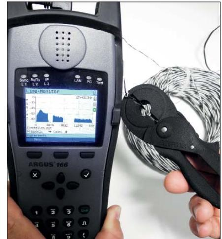
Bild 4: Ein Messgerät monitort mithilfe einer Stromzange, die nur eine von beiden Adern umschließt, das Nutzsignal, hier VDSL2 Profil 17a. Zur Störersuche sind beide Adern zu umschließen
