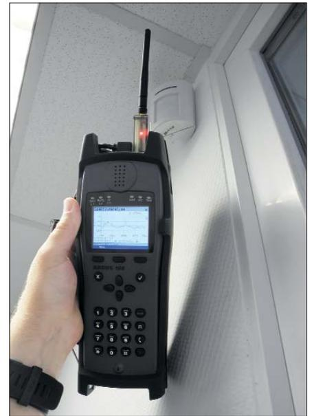
Bild 6: Suche von WLAN-Störern mit Handheld-Messgerät und WLAN-Spektrumanalyse
