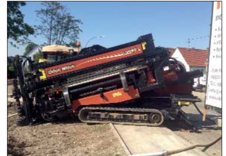
Spülbohranlagen ermöglichen das Verlegen von Leerrohren ohne umfangreiche Tiefbauarbeiten (Foto: M-net)
