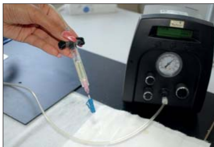
Bild 2: Hier wird der Kleber in den Stecker injiziert
