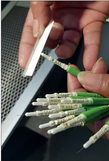
Bild 4: Abtrennen überstehender Fasern mit einem sauberen Schnitt
