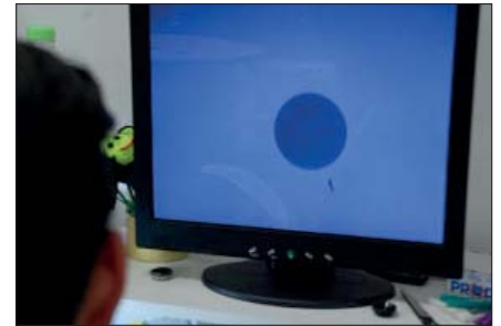
Bild 7: So sieht eine sauber polierte Steckerendfläche aus
