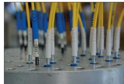
Bild 3: Im Heizofen kann der fertig präparierte Stecker aushärten
