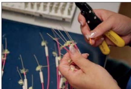
Bild 1: Höchste Präzision ist beim Entfernen des Buffers gefragt
