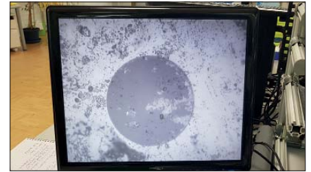
Bild 6: Verschmutzte, schlecht polierte Steckerendfläche
